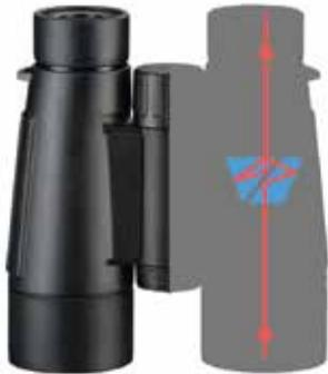
Prismenferngläser funktionieren nach dem Kepler-Fernrohr-Prinzip und enthalten ein Umkehrprisma zwischen Okular und Objektiv, welches einerseits das um 180° verdrehte Bild zurückdreht und andererseits bei hochwertiger Abbildung eine kompakte Bauweise ermöglicht.
